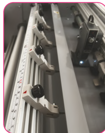
Zestaw ostrzy Y zamontowanych na trymetrze gotowe do cięcia
