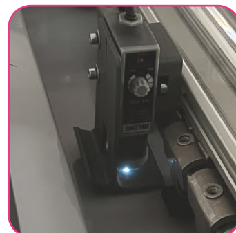
Czujnik wykrywający markery cięcia.
