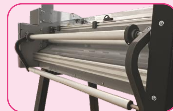
Wychylne ramię napinające do produkcji o dużym wolumenie.
